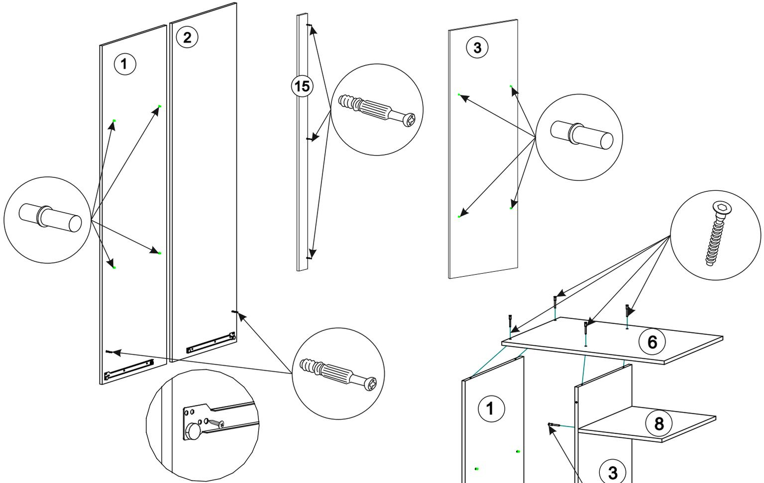
3. Соедините между собой стойку -№3 и вязки №7, 8 и 10 евроинтами 6x50. Присоедините боковину №1 соедините ее с вязками №7 и 10. Приверните дно №5 и крышку №6 к боковине №1 и стойке №3 евроинтами. Соедините планку №16 с боковиной №1 и затяните эксцентриковую стяжку.
