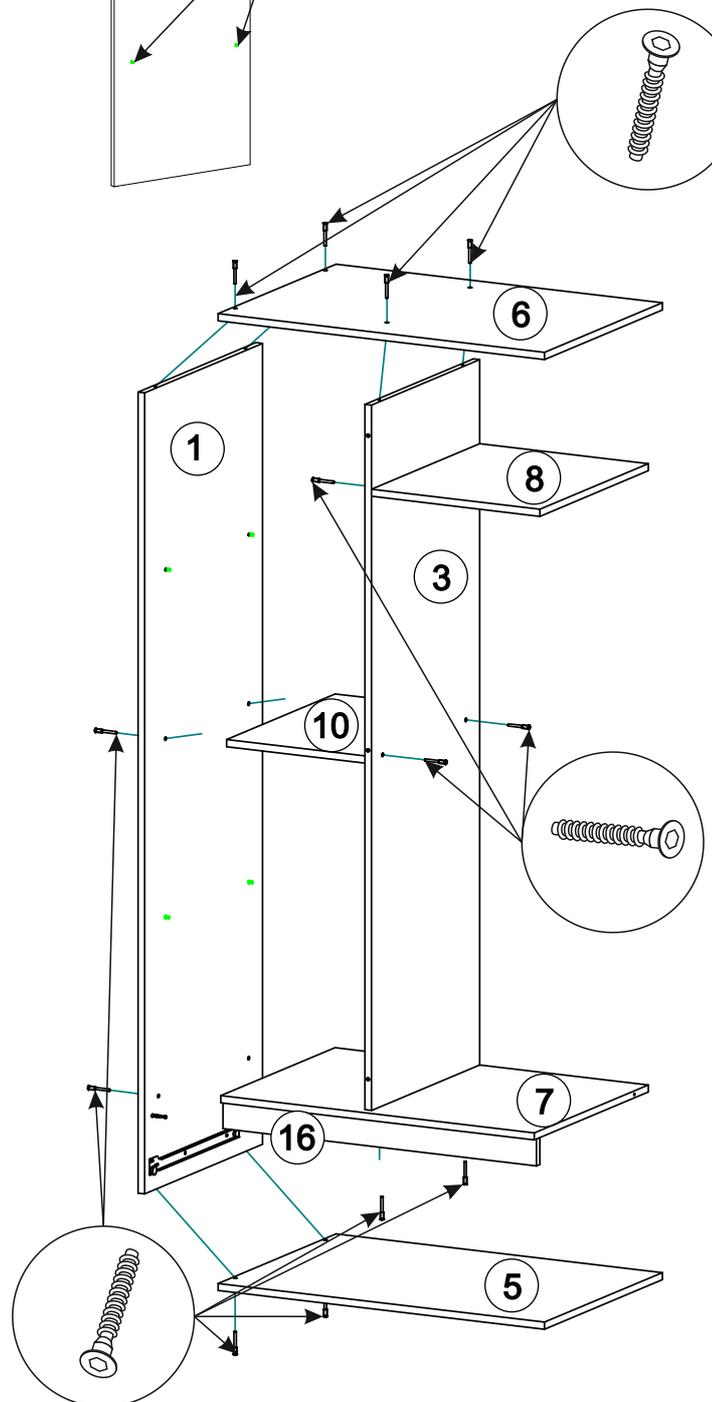
Монтаж эксцентриковой стяжки
