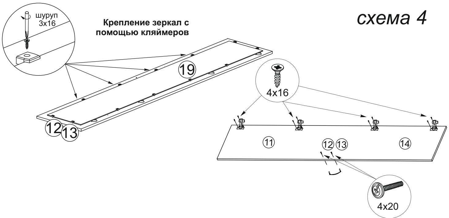
6. Установите шкаф на место. Створки №11 и №14 установите на боковины №1 и №2 соответственно а створки с зеркалом №12 и №13 на перегородки №3 и №4, как показано на схеме 5. Зазоры отрегулируйте по схеме приведенной выше.
