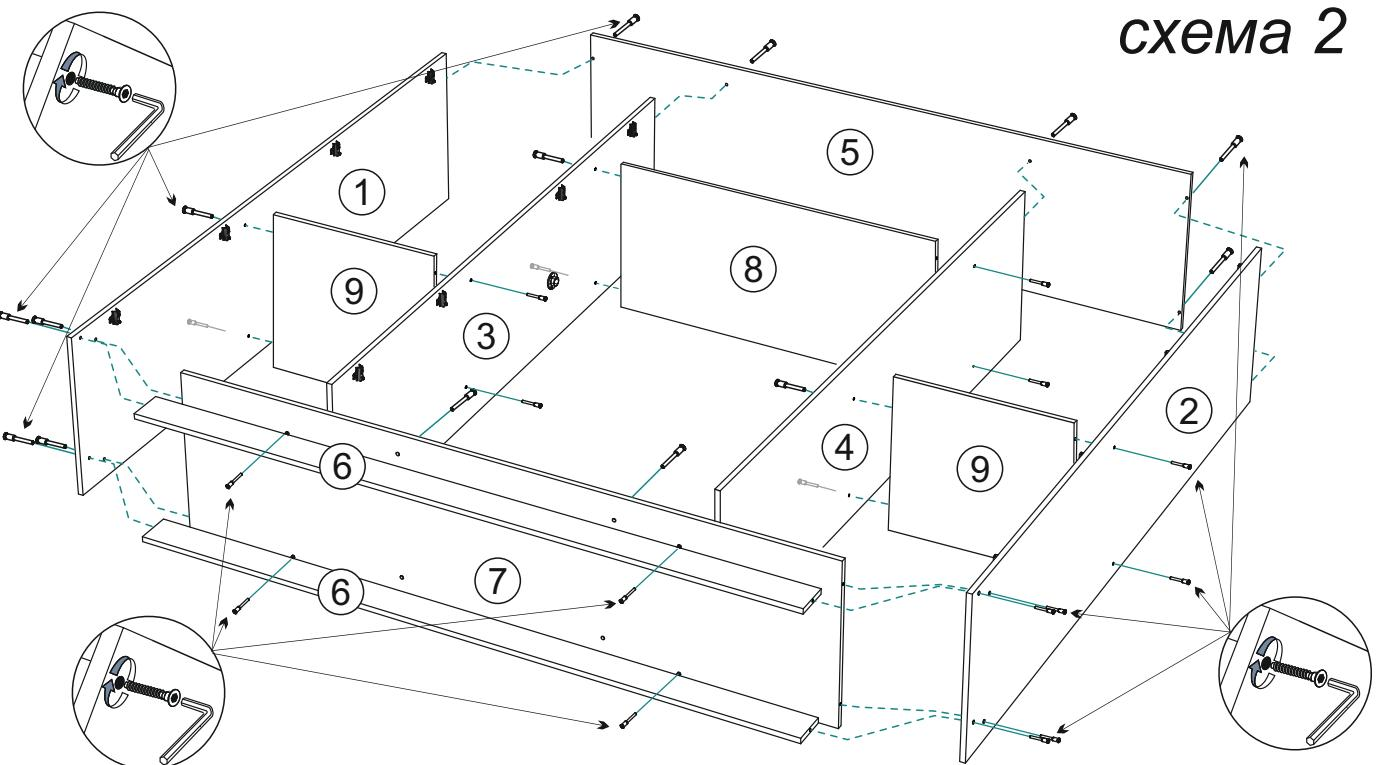
4. Чтобы установить задние стенки (детали №15, №16), необходимо сбранную конструкцию перевернуть лицевой стороной вниз. Замерить, с помощью рулетки, и уронять диагонали ( $a=b$ ). Наложить задние стенки предварительно соединив №16 бруском для ЛДВП №18 и аккуратно, не нарушая диагоналей, прибить ЛДВП гвоздями, с шагом 130-150 мм, затем также гвоздями прибейте подпятники на боковины и цоколя, (схема 3).
